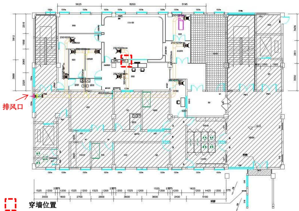
图 10-9 排风系统管线示意图
