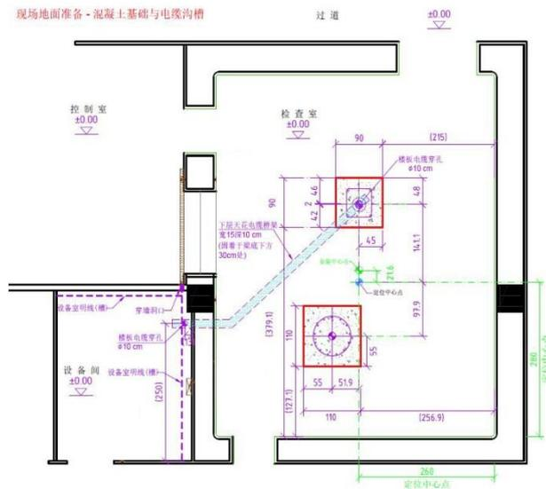
图 10-6 电缆布设示意图
