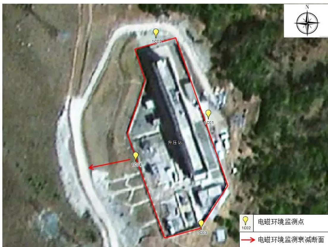
图 4-1 清水朗山风电场 220kV 升压站验收监测布点图
