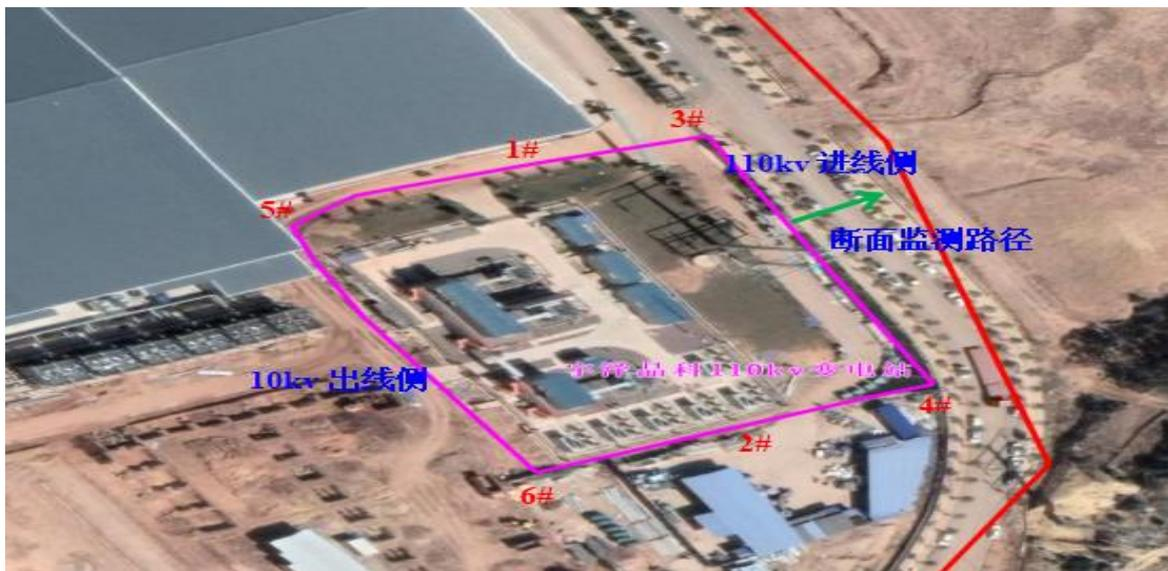
图 1 变电站电磁辐射监测布点图
