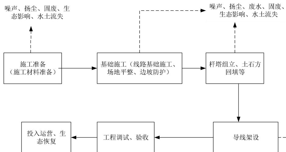
图 2-3 线路施工工艺流程图
