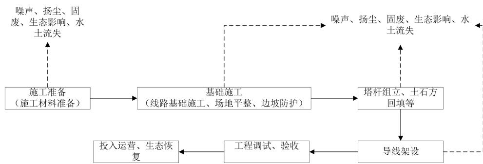
图 4-1 施工期产污环节示意图
