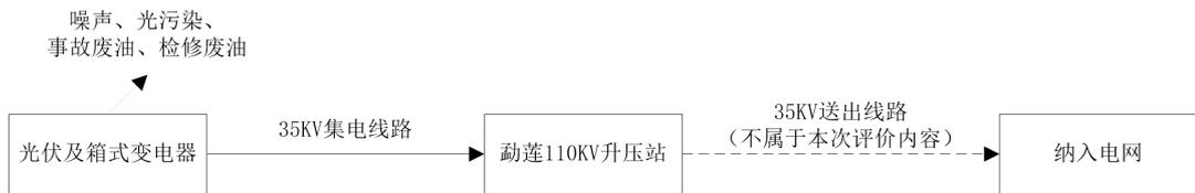
图 4-2 本项目运营期工艺流程及主要产污环节示意图
