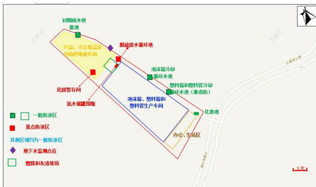
图 5.2-4 防渗分区图和地下水监测点位图
