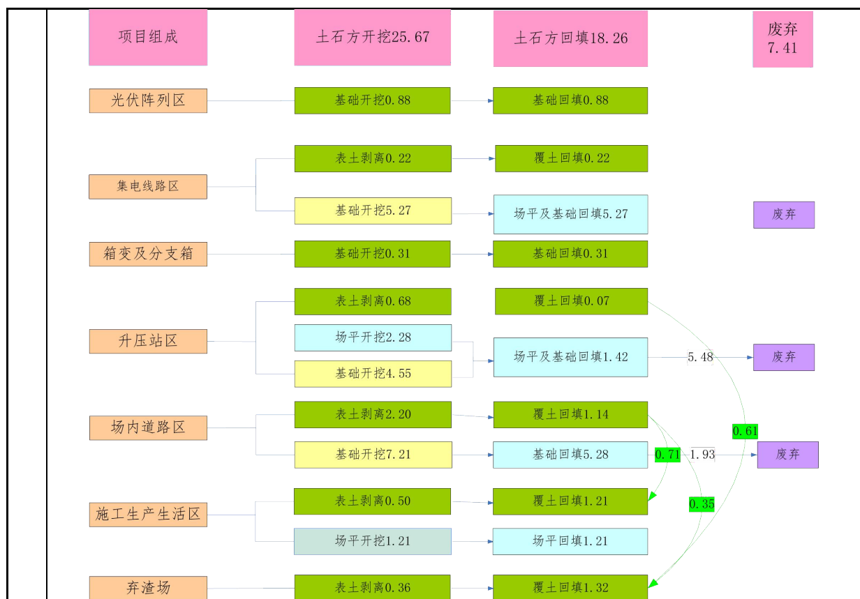
图 2.5-1 土石方平衡流向图
