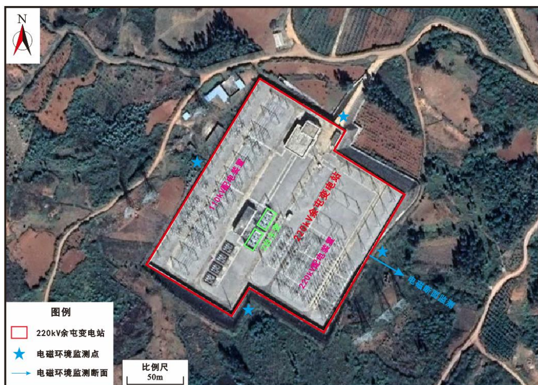
图 17 220kV 余屯变电站监测布点示意图
