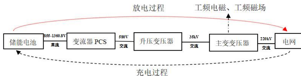
图 2-1 项目运营期工艺流程及产污环节图
