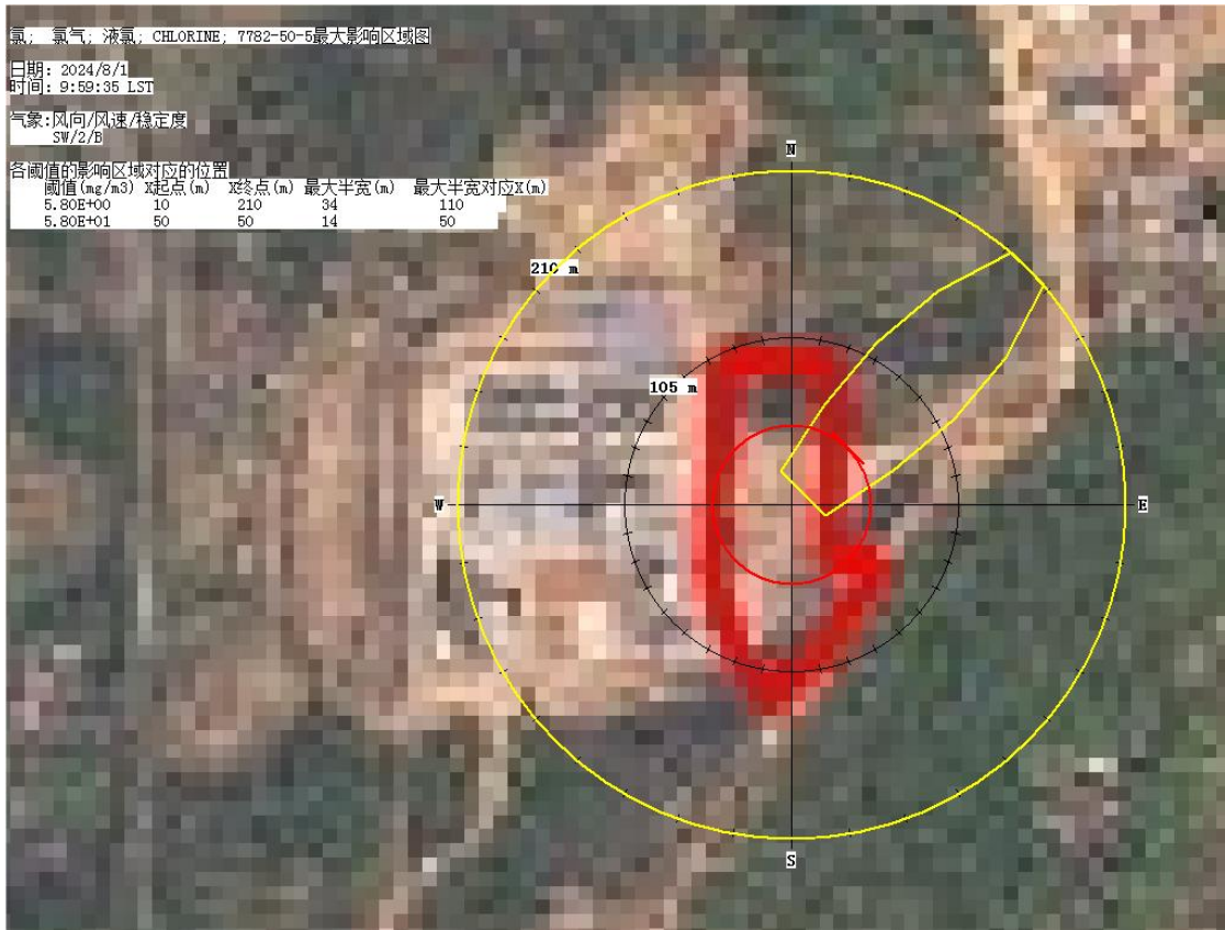
图 7.5.4-6 生产过程氯气泄漏后最不利气象条件下氯气危害区域示意图
