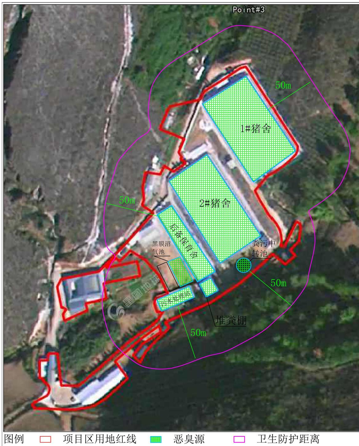
图 6.2-2 卫生防护距离包络线图
