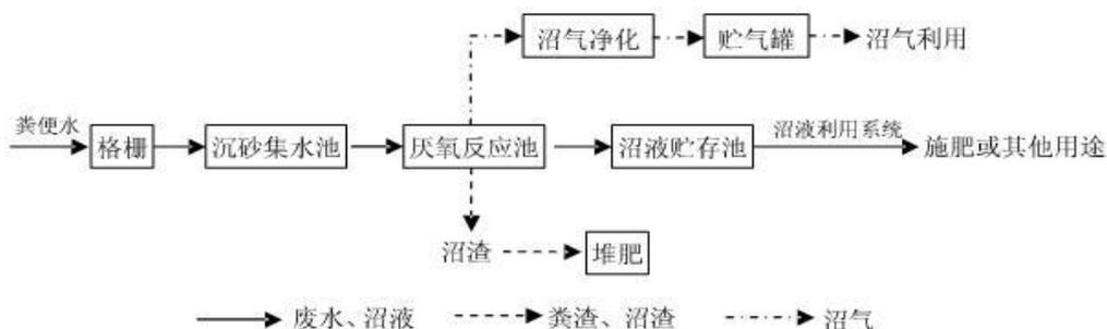
图 6.2-3 模式I工艺基本流程
