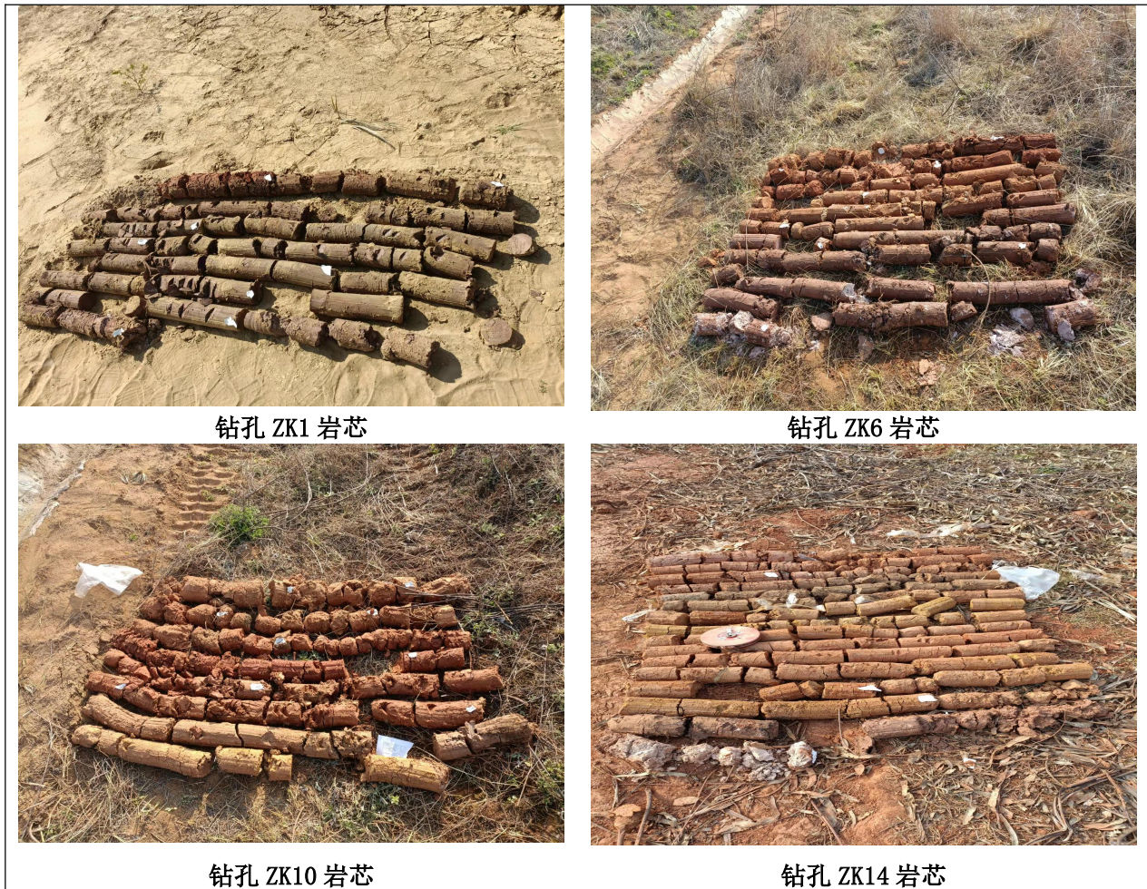
图 6.2-7 部分钻孔岩芯现场照片
