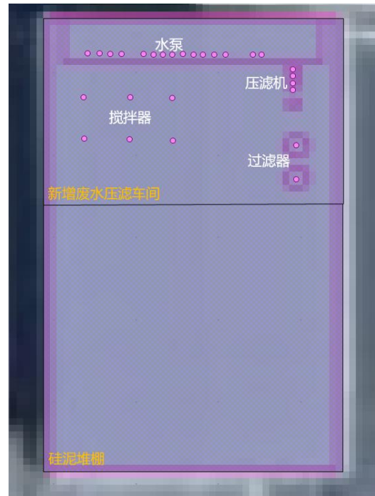
新增废水压滤车间噪声设备分布图
