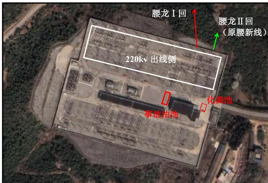
图 3-4 220kV 腰站变平面及出线布置
