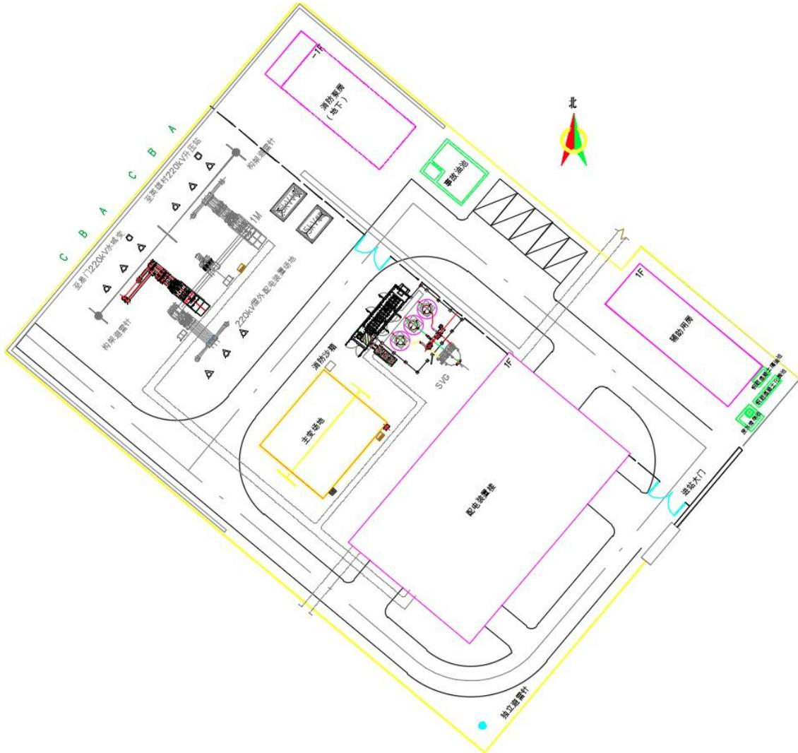
图 2-2 石头光伏 220kV 升压站进出线平面图
