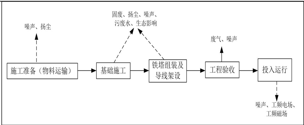
图 2-1 项目架空线路工艺流程及产污环节图
