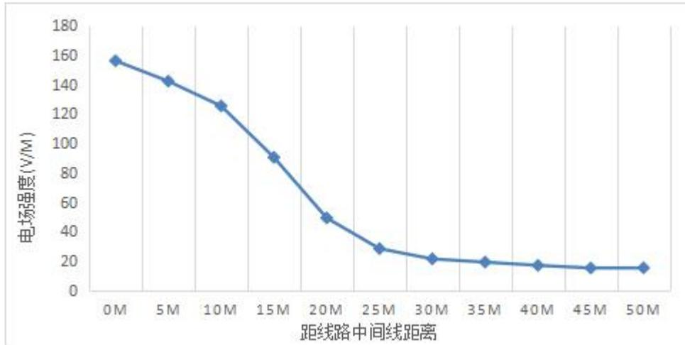
图 8.2-1 110kV 勐典河一级电站至平原便线路工程工频电场强度变化曲线图
