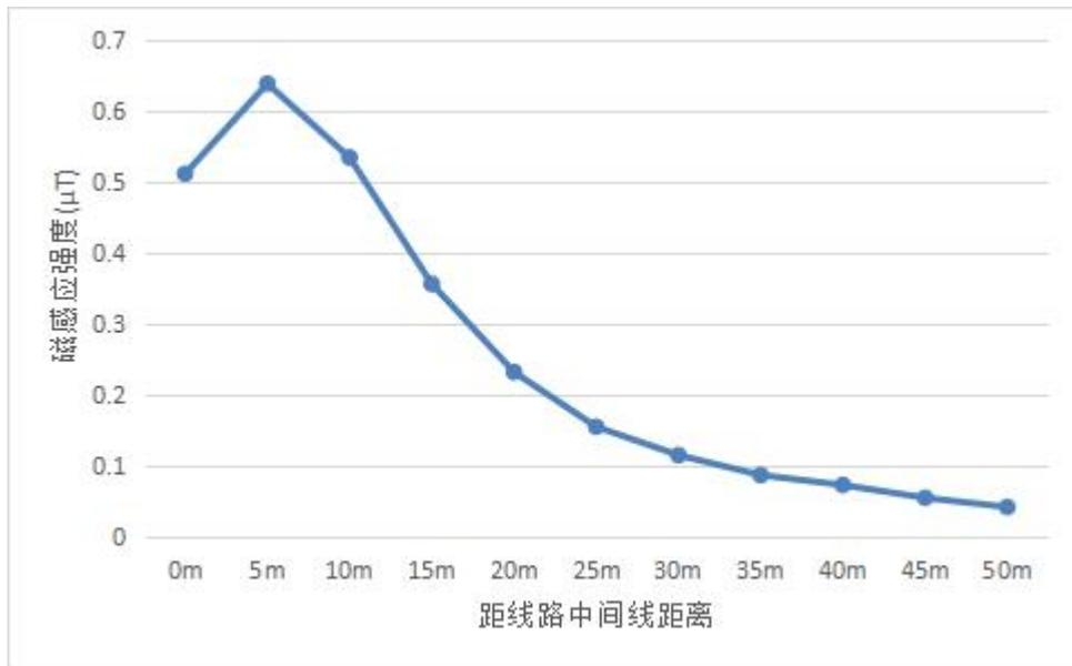
图 8.2-2 110kV 勐典河一级电站至平原便线路工程工频磁感应强度变化曲线图
